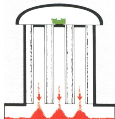
1. Durch manuelle oder automatische Auslösung, wird der Unwuchtrüttler in Schwingung versetzt und die Schlauchflächen gereinigt. Das Material fließt in das Silo zurück.
