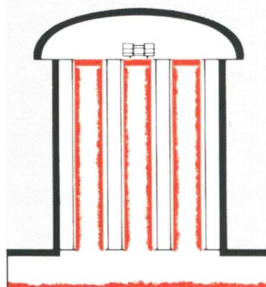
2. Nach Beendigung des Befüllungsvorgangs, ist die Schlauchfiltereinheit von innen mit Staub beaufschlagt.
