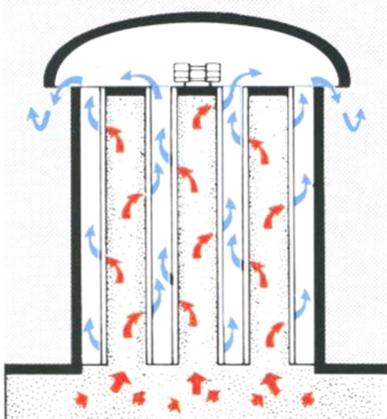
1. Rohgas strömt in die unten offenen und oben verschlossenen Filterschläuche. Reingas entweicht zwischen Filtermantel und Wetterhaube.
