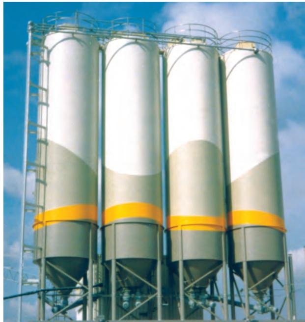
Para los medios de flujo difícil hay que usar inclinaciones más empinadas y la descarga del material a granel tiene que ser fomentada con dispositivos auxiliares de descarga como p. ej. el aflojador por aire LUALO de Stanelle o el cesto oscilante de descarga ASK.
