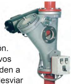
La **boquilla adicional ZD** se monta en conductos de transporte de equipos de alta presión y sobre todo detrás de la válvula de manguera especial SP. Por ella se introduce adicionalmente gas de arrastre en el conducto de transporte. Cambiando el elemento de la boquilla se varía la mezcla polvo-gas.
