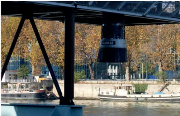
El cargador JET TIPO **RONDO 350 / 400 / 500** de Stanelle con carrera prolongada es idóneo para cargar escombreras y naves. Por las boquillas de succión se puede aspirar la cantidad necesaria de aire de escape de aprox. 2000 - 3000m<sup>3</sup>/h con el equipo de desempolvamiento correspondiente.
