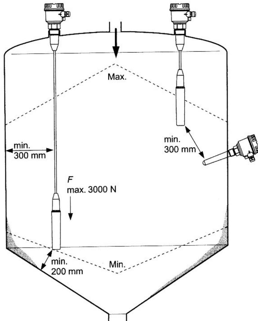
Bei Berechnung der erforderlichen Seillänge, ist der Böschungswinkel des Schüttkegels oder des Abzugtrichters zu berücksichtigen.
