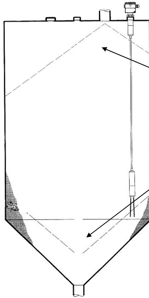
Bei Berechnung der erforderlichen Seillänge, ist der Böschungswinkel des Schüttkegels oder des Abzugtrichters zu berücksichtigen.
