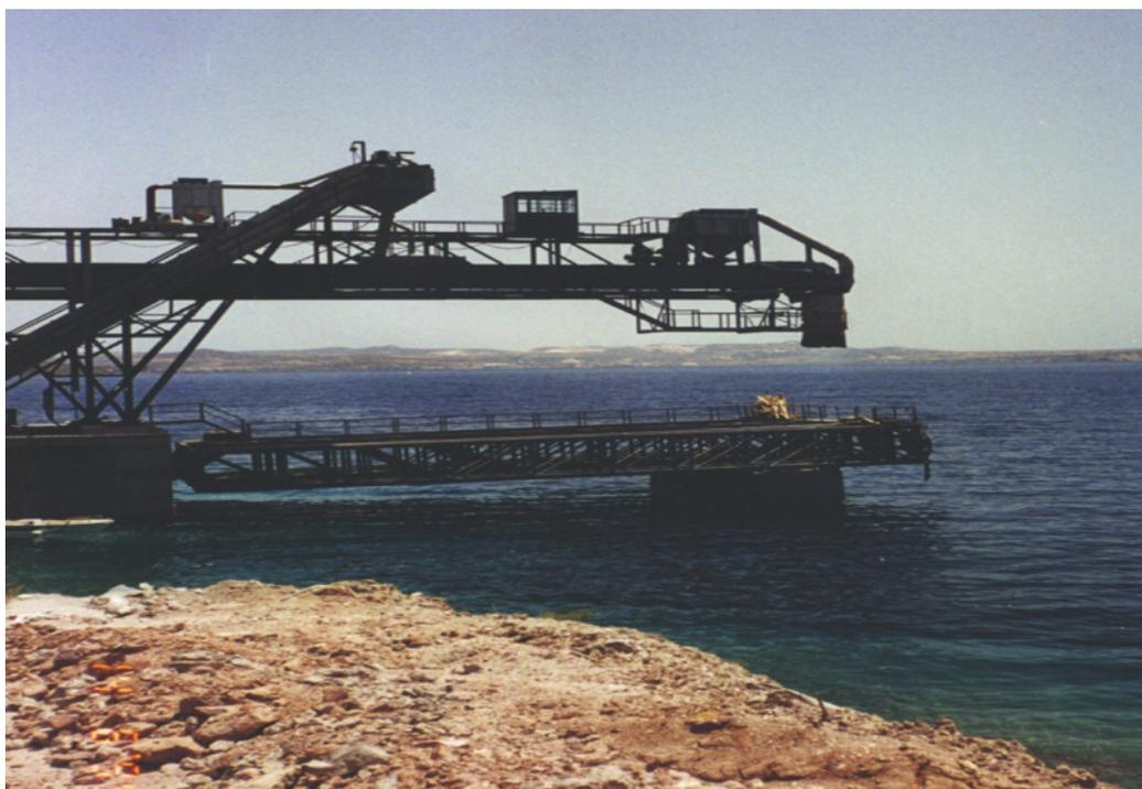
Die Belader Typ JBM 500 sind Spezialbelader, zur Beladung von trockenen, rieselfähigem Schüttgut, auf Schiffen.
