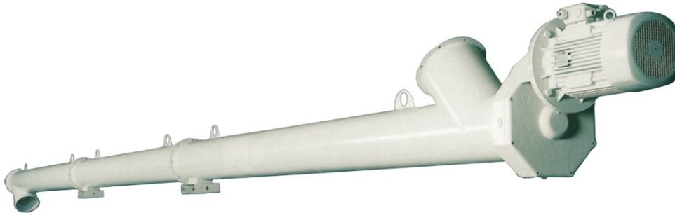
Förderschnecken zur horizontalen und ansteigenden Förderung (bis 45°) von trockenen, pulverförmigen bis körnigen Schüttgütern. Standardrohrdurchmesser und ein Baukastensystem zum Aufbau der Schnecken, garantieren Qualität und ein optimales Preis-Leistungs-Verhältnis
