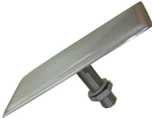
Die Kissenauflockerung wird zur Fluidisierung schlecht fließender, technisch trockener, nicht klebender, pulverförmiger Produkte eingesetzt. Der Einsatz während des Materialabzuges in pulsierender Folge wird empfohlen.
