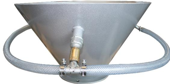
PL3 mit Ringset, Magnetventil, Wartungseinheit (eingebaut am Silokonus)
