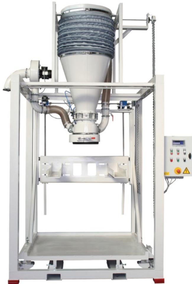
Die mobile BIG-BAG Befülleinrichtung SBB 1000 M kann überall eingesetzt werden wo eine BIG-BAG Befüllung über ein bestehendes Verladesystem z.B. STANELLE JET BELADER RONDO/QUADRO vorhanden ist.
