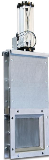
Der **Flachschieber TYP SMFS** wird an Silo- und Behälterausläufen eingesetzt. Er garantiert optimale Abdichtung bei Lagerung von staubhaltigen oder granulatformigen Schüttgütern bis 8 mm Korngröße. Die Ausführung „Pneumatikschieber“ dient als Dosierschieber. Der modular aufgebaute Schieber ermöglicht bei gleichem Grundrahmen den Anbau der verschiedenen Antriebsarten Hand-, Pneumatik- und Elektromotorischen Antrieb.
